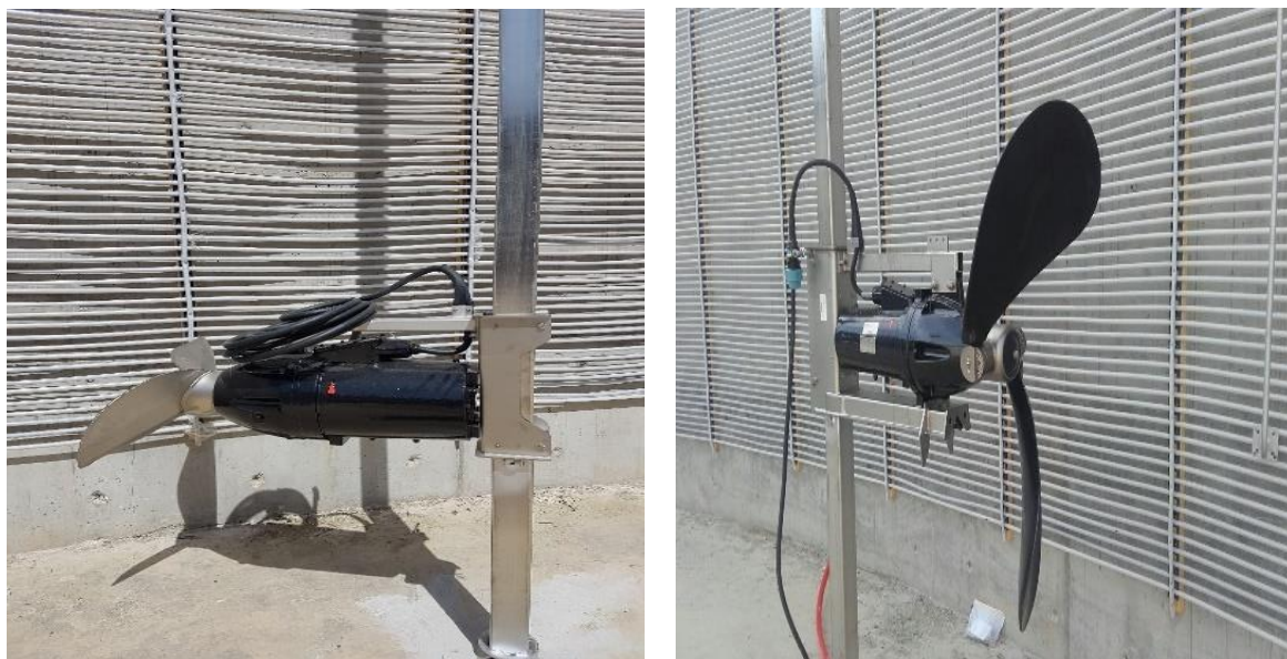
Εικόνα 27 : Αναδευτήρες υψηλής και χαμηλής ταχύτητας (ενδεικτική φωτογραφία)
