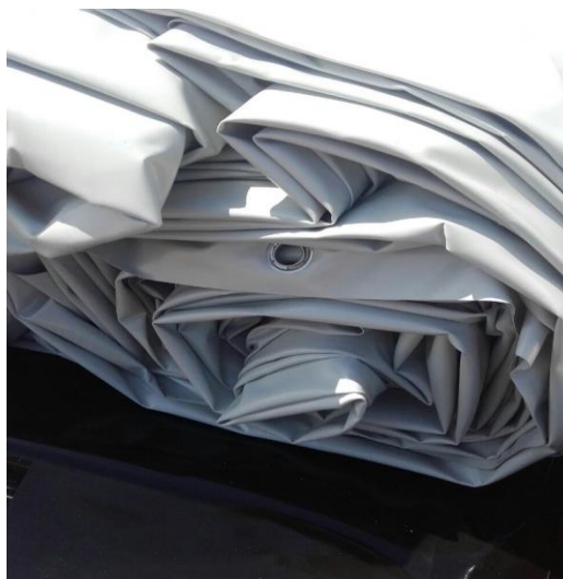
Εικόνα 24 : Άνω μεμβράνη PVC – προστασίας καιρικών φαινομένων (ενδεικτική φωτογραφία)
