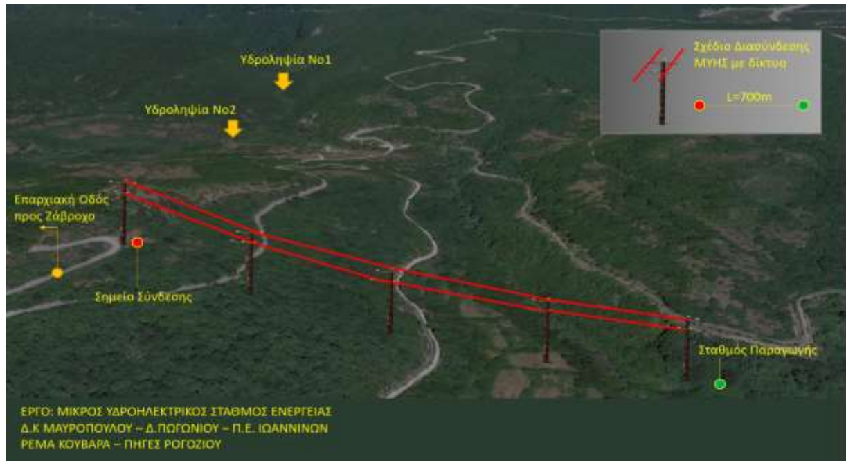
Εικόνα 21: Σχέδιο σύνδεσης του ΜΥΗΣ στο δίκτυο ΜΤ
