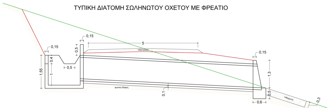
Σχήμα 6.3: Τυπική διατομή οχετού με φρεάτιο
